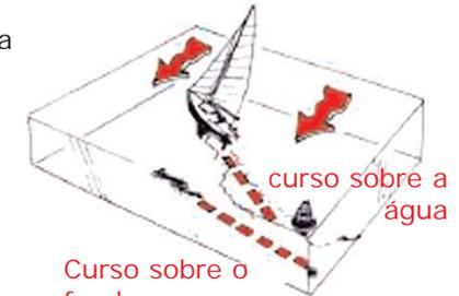
**POSIÇÃO BURRA** é a posição calculada levando-se em conta o rumo seguido (proa) e a distância navegada (velocidade da embarcação em um certo período de tempo). Não leva em conta as correntes nem o abatimento
